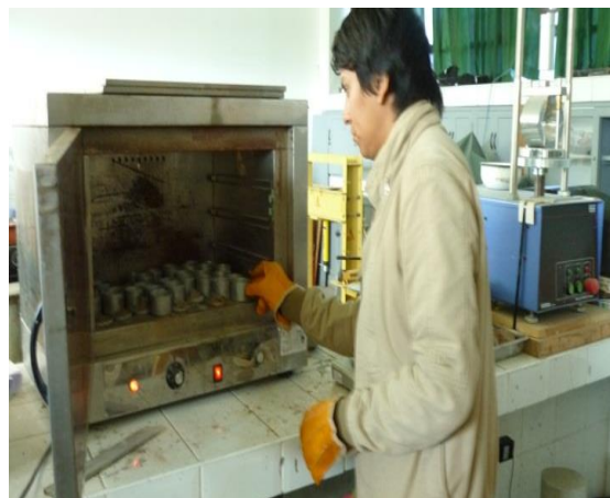
COLOCACION DE MUESTRAS AL HORNO LIMITE LÍQUIDO Y LIMITE PLASTICO
