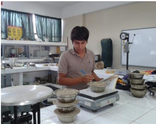
REGISTRANDO PESO DE TARA + MUESTRA SECA
