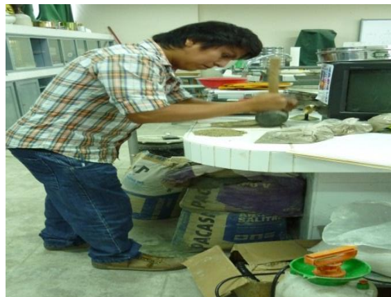
PULVERIZANDO MUESTRA PARA ENSAYO DE LÍMITE LÍQUIDO Y LIMITE PLASTICO
