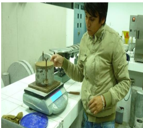
PESADO DE MUESTRAS HUMEDA + MOLDE
