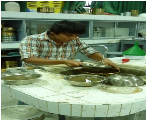
LAVADO DE LA MUESTRA PREVIA AL TAMISADO (N°200)
