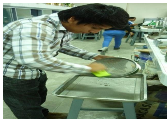
ESTRAYENDO LAS PARTICULAS RETENIDAS EN LAS MALLAS Y PESANDO LOS PESOS RETENIDOS.
