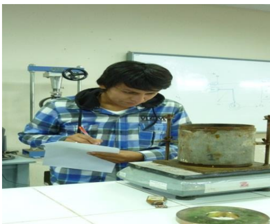
REGISTROS DE PESOS DE MUESTRAS HUMEDA +MOLDE ENSAYO CBR
