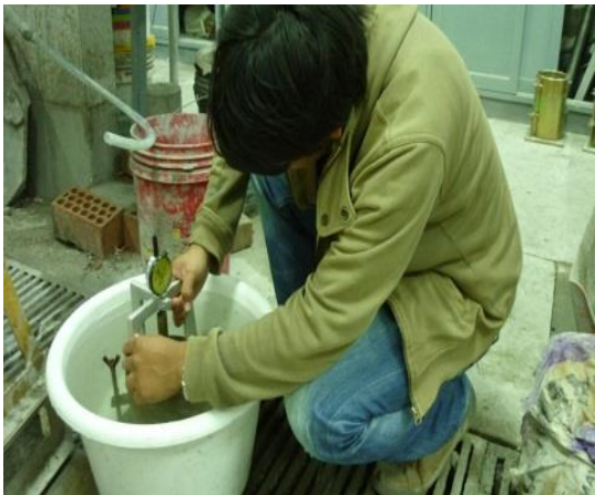
REGISTRO DE EXPANSION DEL MATERIAL – ENSAYO CBR
