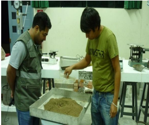
COLOCACION DE AGUA DESTILADA A MUESTRA SATURADA PARA PROCTOR
