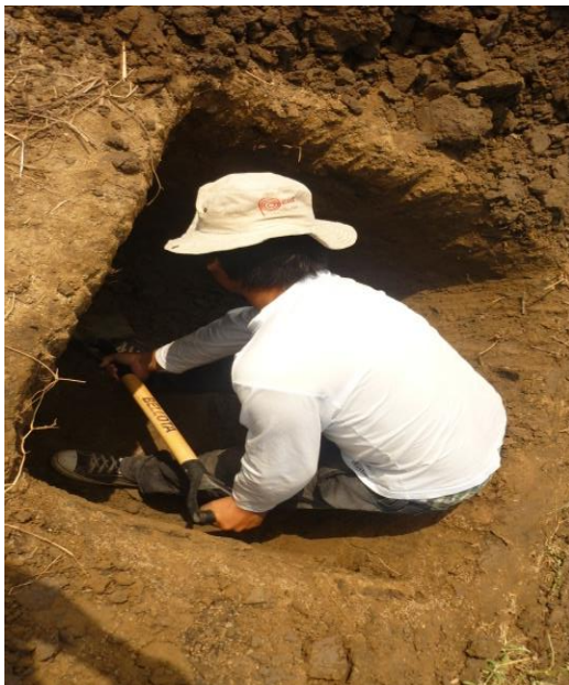
EXAVANDO CALICATA Y VERIFICANDO EXCAVACION AL 1.50MT
