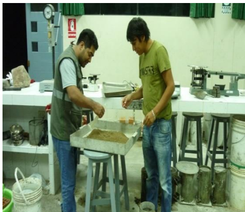
VERIFICACION DE UNIFORMIDAD DE CONSISTENCIA DE SUELO
