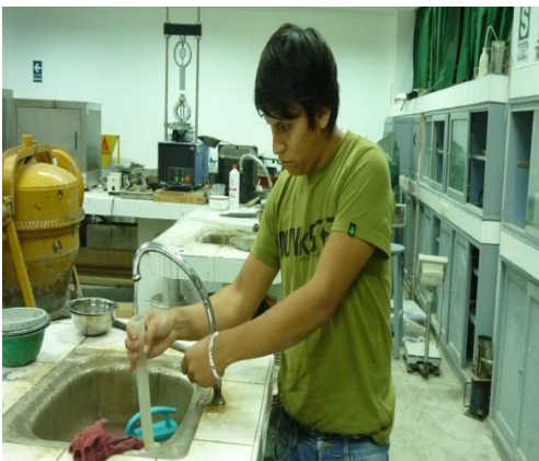
MEDICION DE AGUA DESTILADA A SER USO EN ENSAYO PROCTOR
