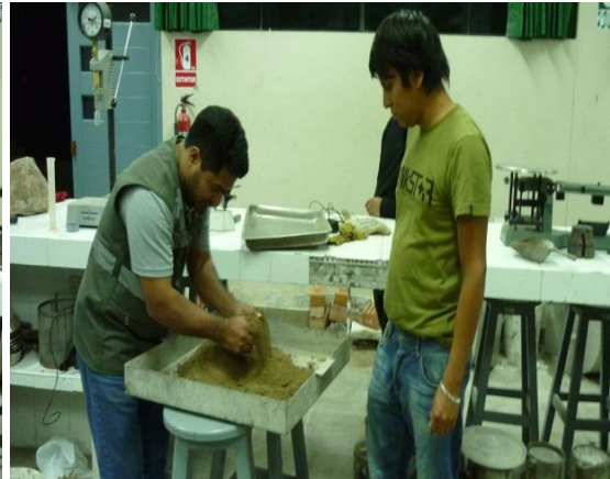
UNIFORMIZANDO MUESTRA SATURADA
