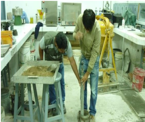
ENSAYO PROCTOR 56 GOLPES POR CAPA
