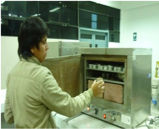
COLOCACION DE MUESTRAS AL HORNO - ENSAYO CBR
