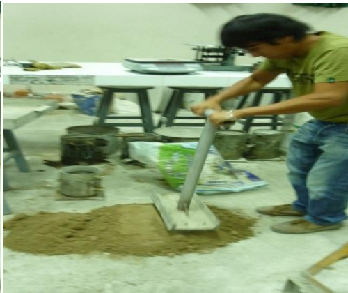
LA MUESTRA ES UNIFORMIZADA MACHACANDO LOS TERRONES EXISTENTES
