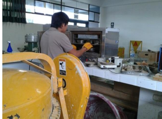
COLOCANDO LAS MUESTRAS EN EL HORNO 105°
