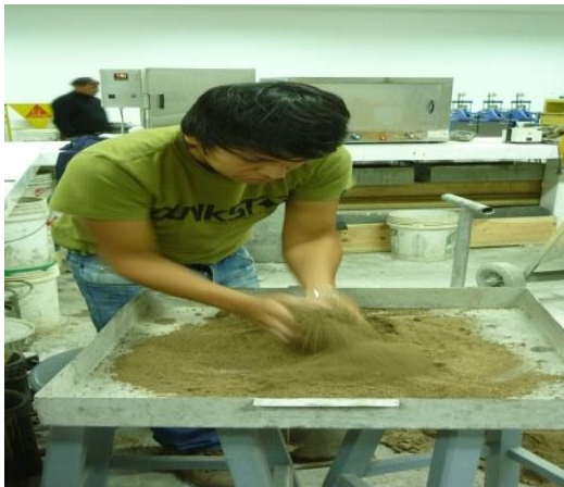
UNIFORMIZANDO MUESTRA SATURADA
