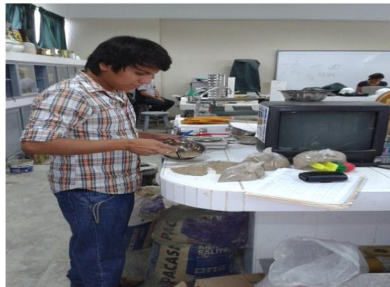
SELEC., 4TA PARTE PARA ANALISIS GRANULOMETRICO
