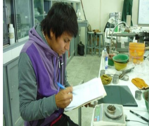
REGISTRANDO DATOS OBTENIDOS DE LIMITE LÍQUIDO Y LIMITE PLASTICO
