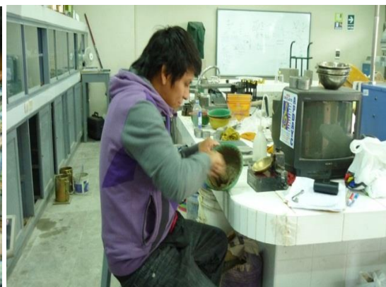
REALIZANDO PASTA DE MATERIAL PREVIO A ENSAYO LIMITE LÍQUIDO Y PLASTICO
