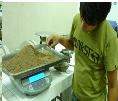
PESANDO LA MUESTRA PARA ENSAYO PROCTOR
