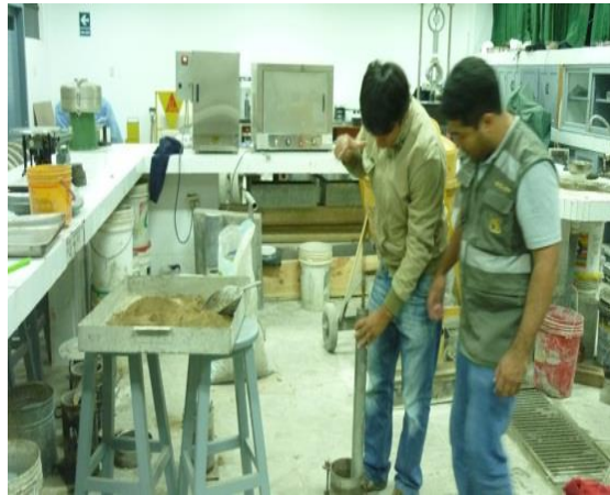
ENSAYO PROCTOR 56 GOLPES POR CAPA
