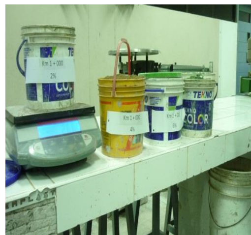
IDENTIFICACION DE MUESTRAS PREPARADAS PARA ENSAYO PROCTOR
