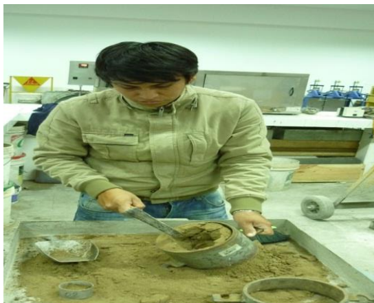
EXTRACCION DE MUESTRAS DEL MOLDE
