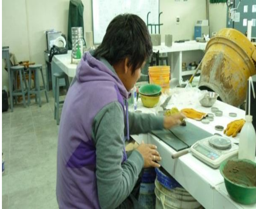
ENROLLANDO MUESTRA DE SUELO PARA ENSAYO DE LIMITE PLASTICO
