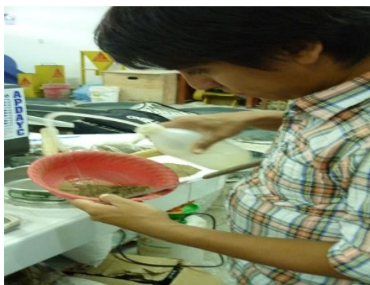
HABIENDO PASAD POR LA MAYA N°40, COLOCAMOS AGUA DESTILADA PARA SATURAR
