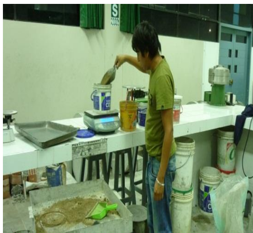
PESADO DE MUESTRAS PREVIO A ENSAYO PROCTOR
