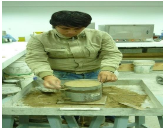
ENRRASADO DE MUESTRA EN MOLDE METALICO
