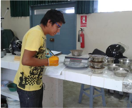
REGISTRANDO PESO DE TARA + MUESTRA HUMEDA
