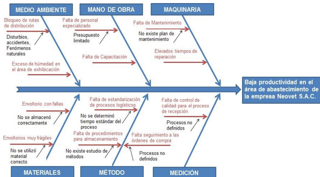
Figura 1: Adaptación del Diagrama de Ishikawa para la baja productividad en el área de abastecimiento de la empresa Neovet S.A.C.
