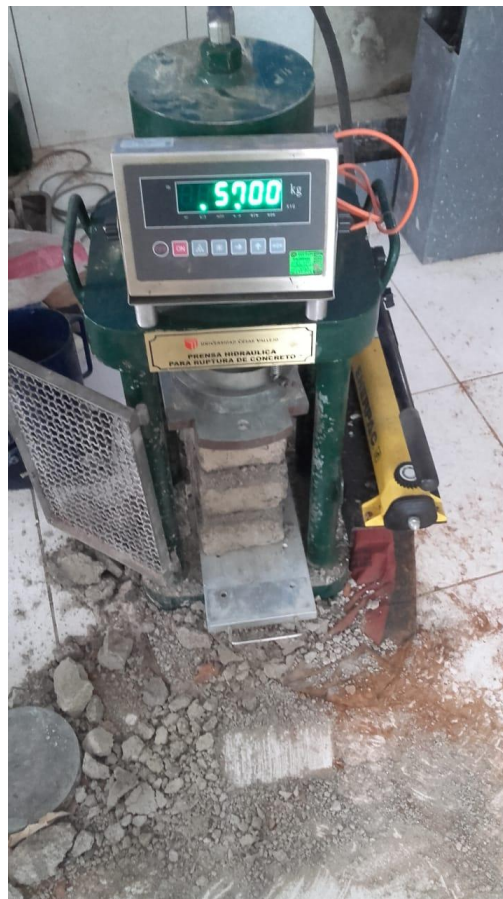
FIGURA 37 ensayo de compresión a las muestra de ladrillos
