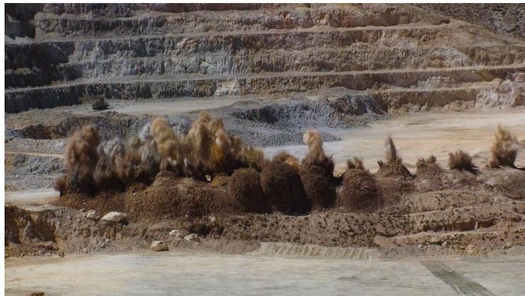
Gráfico 10: Proceso de Voladura en Mina a Tajo Abierto
