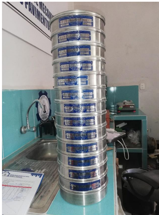
Figura 6: Tamices usados para el ensayo de análisis granulométrico por tamizado Fuente: Propia
