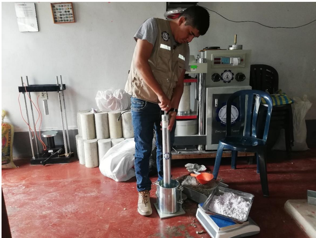
Figura 4: Proctor modificado por capas.
