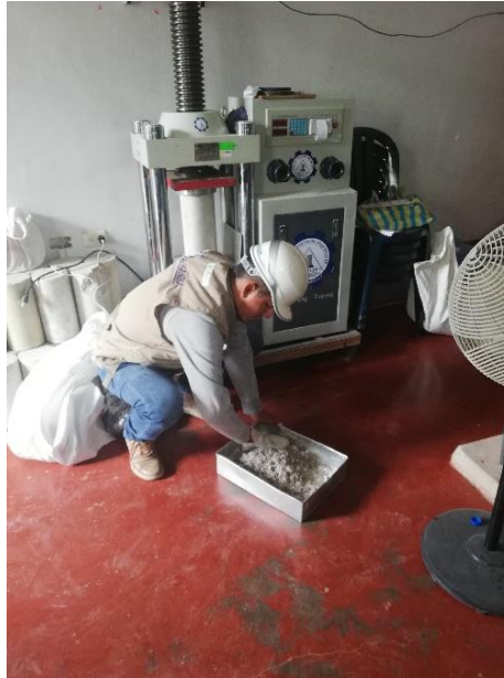
Figura 8: Mezcla de Suelo Arcillo y Ceniza de cascara de arroz
