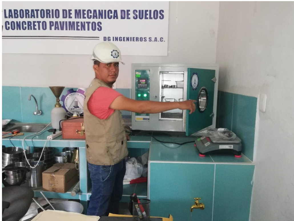
Figura 3: Poniendo las muestras en el horno para el calculo de contenido de humedad.
