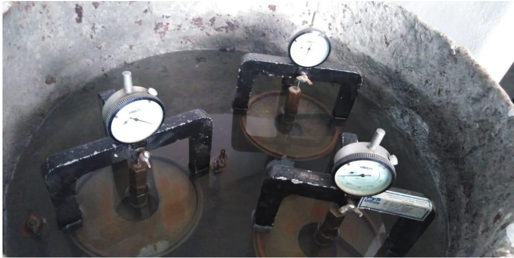
Figura 5: Muestra sumergida para calculo de % de absorción.
