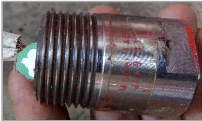
Figura 9. Sensor de vibración.
