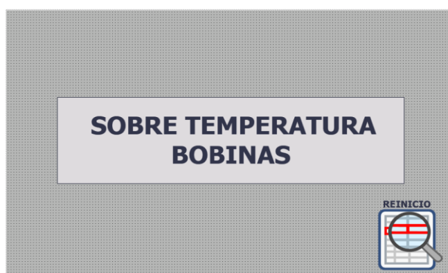
Figura 31. Pantalla con falla que origina fuera de servicio.
