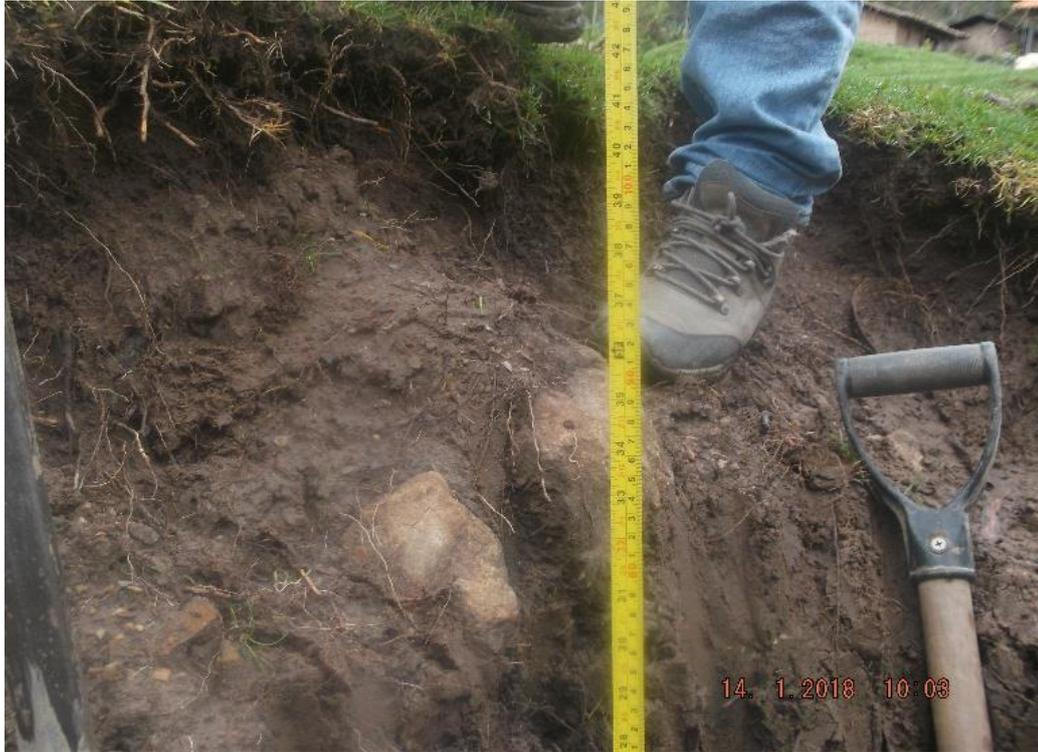
Figura 20: Se observa realizando la medida de la profundidad de la calicata..
