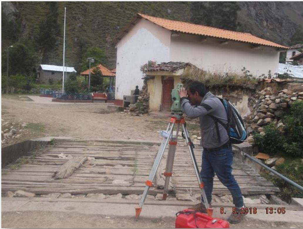
Figura 14: Se observa al técnico realizando captura de puntos.
