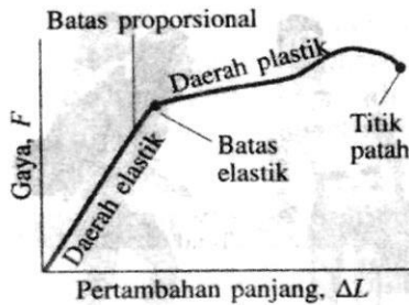
Gambar 6.9. Gaya yang diberikan terhadap pertambahan panjang untuk logam biasa dibawah tegangan
