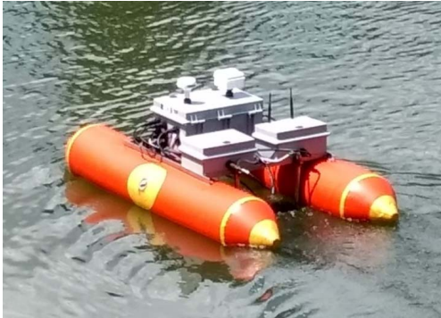
Fig. 1. ASV-MACÁBOT, destacándose los flotadores de PVC y las cajas estancas para electrónica y baterías montadas sobre el chasis de acero inoxidable.
