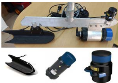
Fig. 2. Sensores acústicos montados en la quilla (arriba) consistentes en: SONAR de barrido lateral StarFish, ecosonda Super SeaKing y SONAR de barrido frontal Micron, equipos de la firma Trittech® (abajo, de izquierda a derecha).
