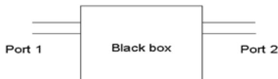
Gambar 1. Diagram sederhana sebuah jaringan dengan 2 *port*
