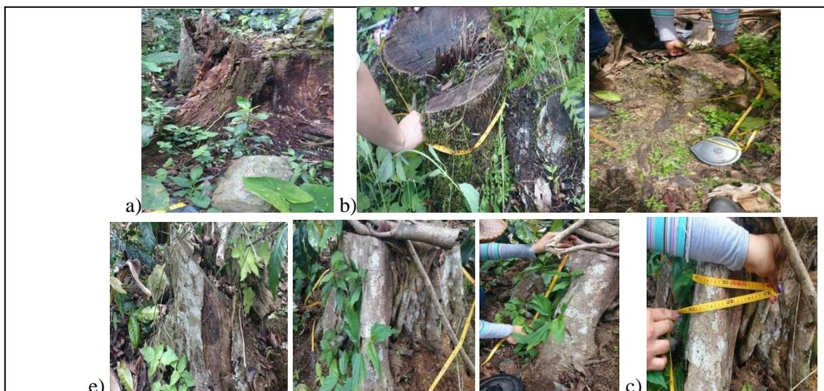
A los tocones regulares(a) se les midió las alturas y los diámetros altos y bajos(b), diferente al tocon irregular al cual, además de medir el diámetro general y las alturas(e), se le midió el diámetro y longitud de cada estructura externa o raíz expuesta(f).
