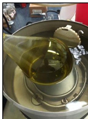
Imagen 9. Rotaevaporador donde se concentran los diferentes extractos de las hojas Ch. perglabra (B. L. Robinson) R.M. King & H. Robinson (Fuente: Autor).
