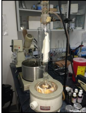
Imagen 10. Equipo para la Extracción sólido-Líquido con cartucho para el fraccionamiento de los extractos hojas Ch.perglabra (B. L. Robinson) R.M. King & H. Robinson. (Fuente: Autor).
