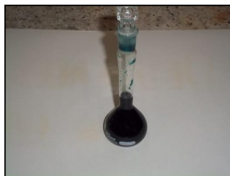
Imagen 13. El radical ABTS^{*+} generado químicamente con persulfato de potasio después de un periodo de 48 horas en la oscuridad. (Fuente: Autor).
