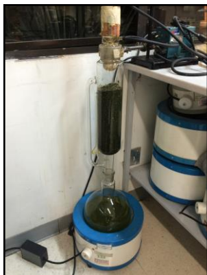
Imagen 8. Equipo Soxhlet para la extracción de las hojas Ch. perglabra (B. L. Robinson) R.M. King & H. Robinson (Fuente: Autor).
