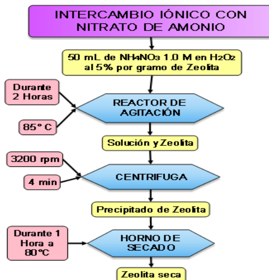
Figura 13. Intercambio iónico con nitrato de amonio.
