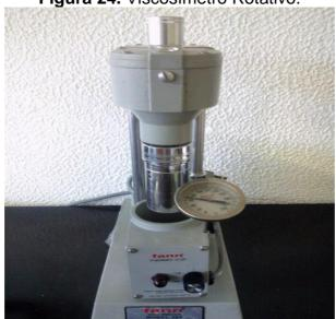
Figura 24. Viscosímetro Rotativo.
