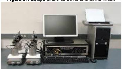
Figura 31. Equipo dinámico de hinchamiento lineal.
