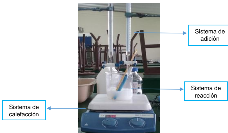
Figura 2-1. Instalación experimental para la síntesis de hidrotalcitas.
