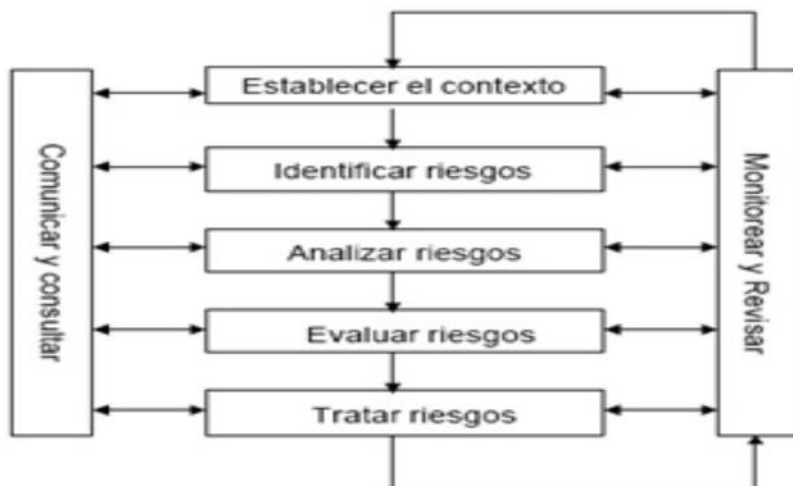
Figura 3. Proceso de Gestión del Riesgo según la norma tomado de: Guía de administración del Riesgo elaborada por el Departamento Administrativo de la Función Pública DAFP.
