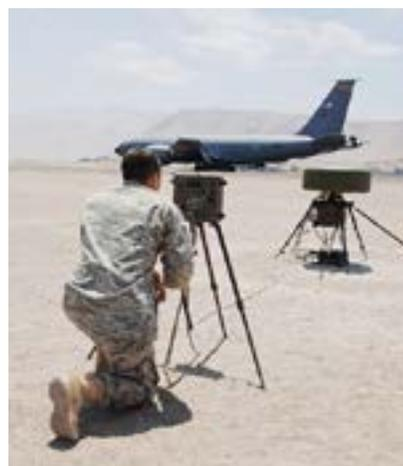
Imagen 14. TACAN (Tactical Air Navigation System) o sistema aéreo táctico de navegación militar
