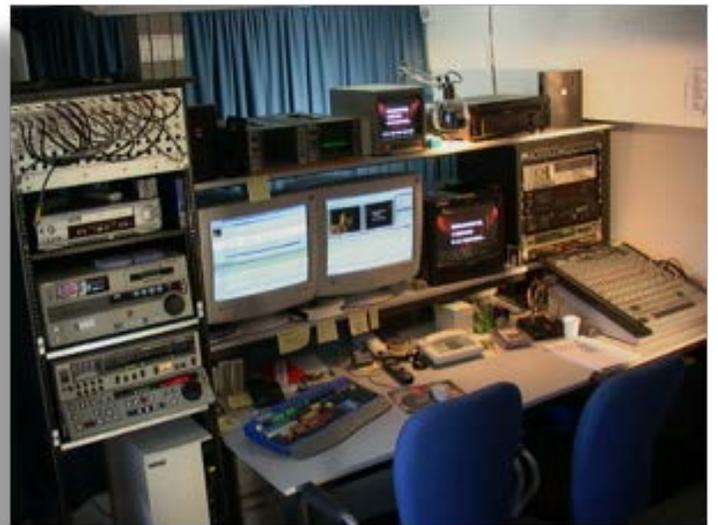
Figura 17: equipamiento para edición lineal de video (ELV, s.f.)
