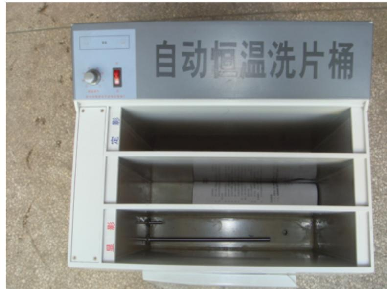
Imagen 2. Tanques de revelado manual. (1) Revelador. (2) Agua. (3) Fijador
