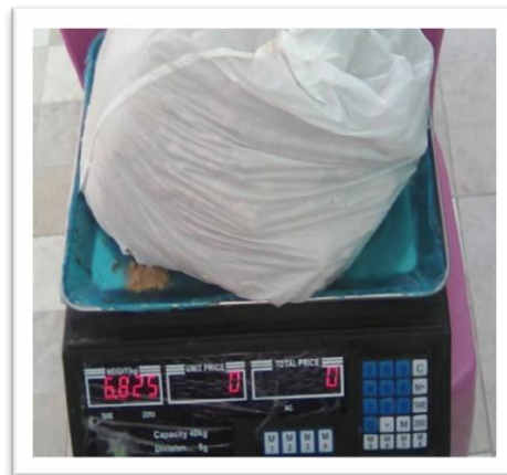
Imagen 11: Cantidad aproximada de arcilla de un ladrillo
