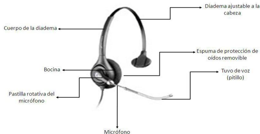
Figura 68. Partes de la Diadema Telefónica (Fuente: <http://www.puntosymercados.com/>)
