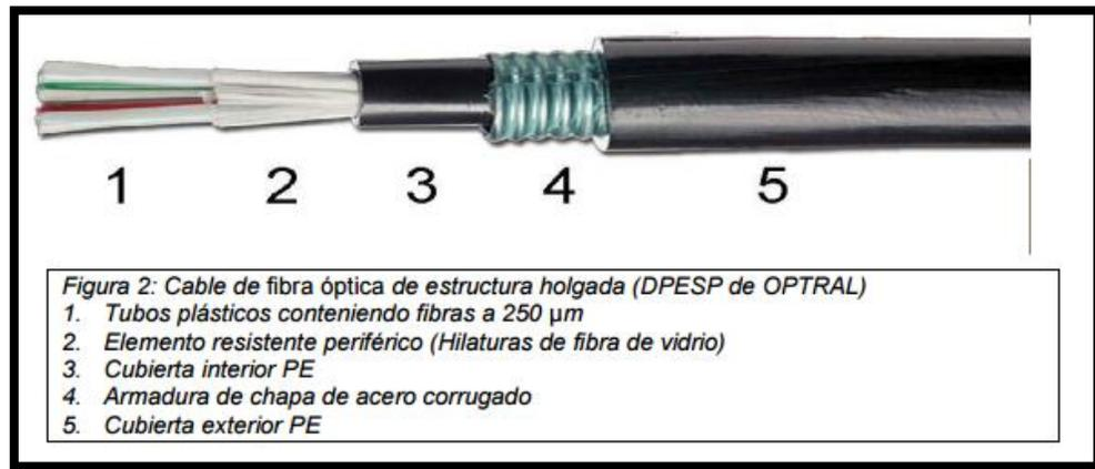
Figura 11 Cable de Figura Óptica de Estructura Holgada (DPESP de OPTRAL) [18]
