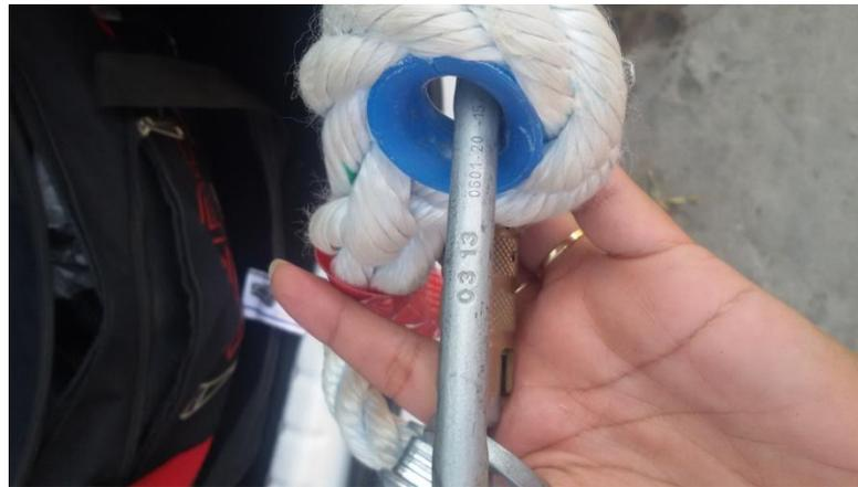
Ilustración 6. Eslinga de posicionamiento, de longitud ajustable con bloqueador de aluminio y mosquetón de cierre automático.
