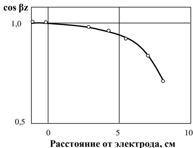
Рис.1.14 – Осевое изменение фазового сдвига ВЧФР
