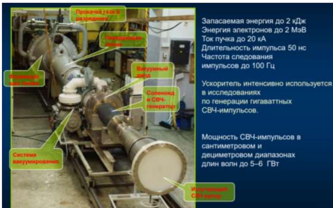
Рисунок 2.2 – Электронный ускоритель «СИНУС – 7».
