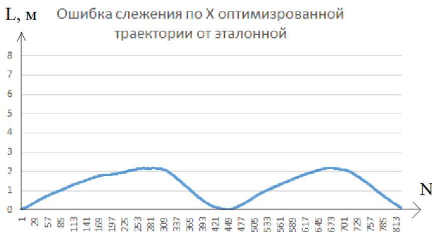
Рисунок 25 – Модуль разницы между эталонной траекторией и построенной поэлементно по оси X.
