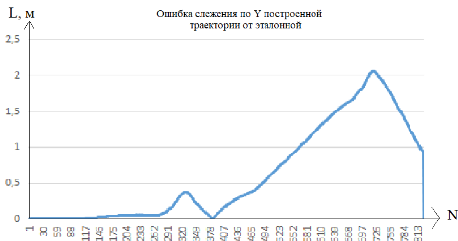
Рисунок 24 – Модуль разницы между эталонной траектории и построенной поэлементно по оси Y.
