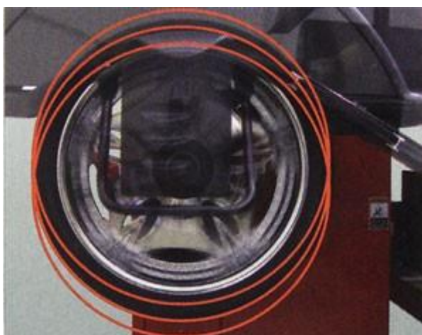
Рисунок 2.6 Схема измерений радиальных и боковых биений колеса
