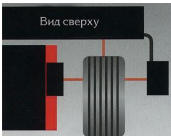
Рисунок 2.7 Измерение радиальных биений колеса
