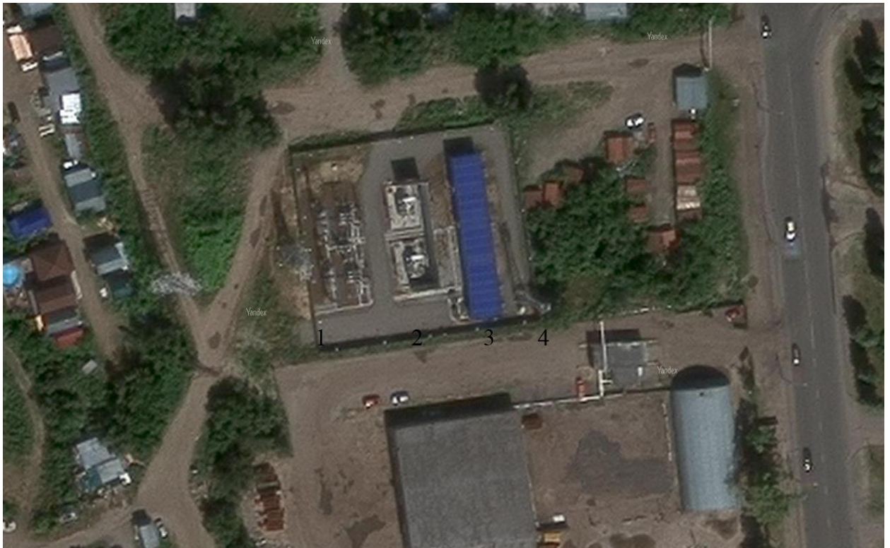
Рисунок 9 –Расположение ПС, 1 – ОРУ; 2 – ТР; 3 – КРУ; 4 - МОЛНИЕОТВОД
