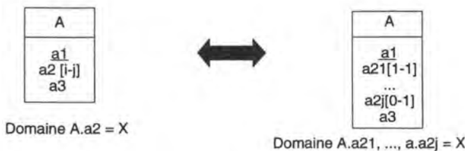
Figure-7 : Elimination d'un attribut multivalué par juxtaposition d'attributs simples.
