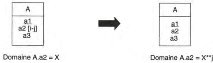
Figure-8 : Elimination d'un attribut multivalué par concaténation.
