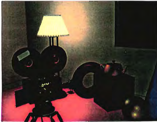
Illustration XIV : Modèle d'illumination totale avec plusieurs sources lumineuses (réflexion diffuse et spéculaire).
