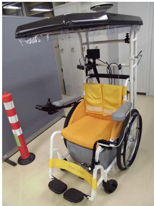
Fauteuil roulant contrôlé par un capteur Leap Motion
