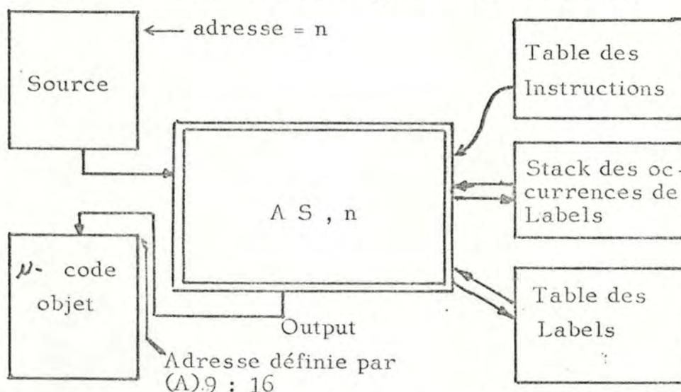
L'instruction AS (Assemble) réalise cette phase de compilation du source en micro-code. Elle fait appel à une table donnant pour chaque instruction le micro-code associé à générer et dispose de deux zones manoeuvre, un stack des occurrences de labels et une table de labels.
