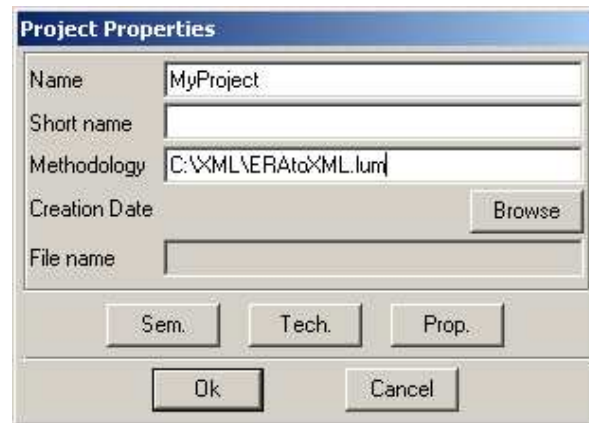
FIG. 3.39 – La fenêtre de création de projet DB-Main : le bouton Browse permet de choisir le fichier ERAtoXML.lum contenant la méthode
