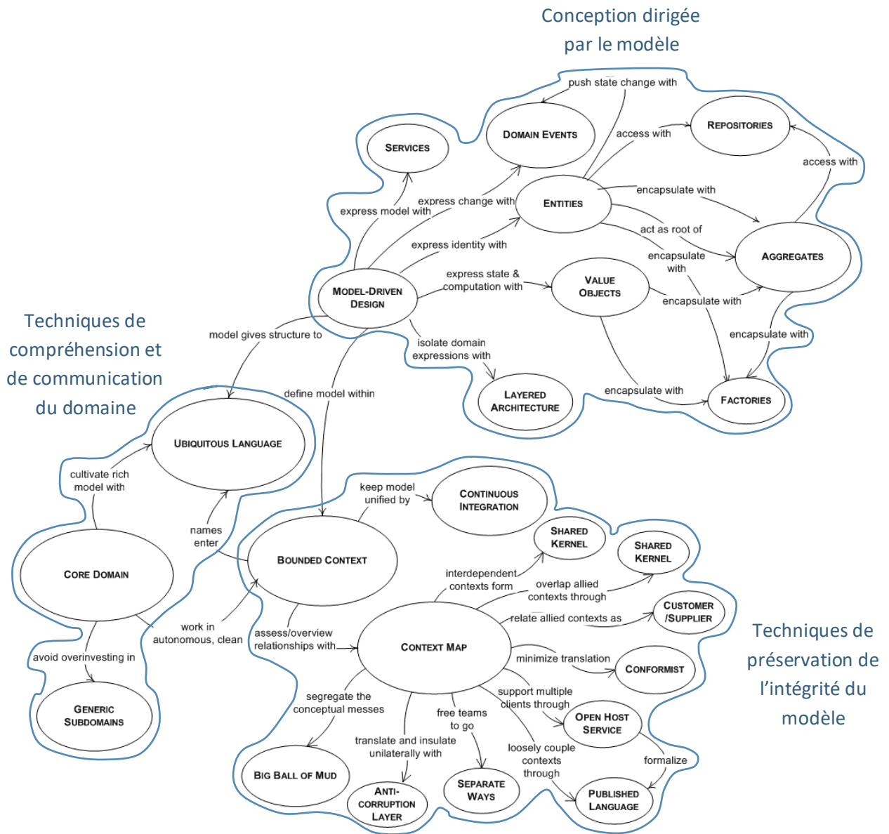
Figure 17 : DDD – Vue d'ensemble [DDD, 2004]
