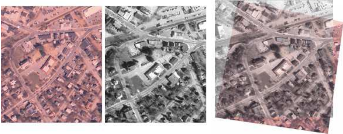
FIGURE 1.1 – Exemple de recalage de photographies aériennes [1].
