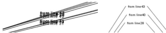
FIGURE 26 – ILLUSTRATION DU PROBLÈME DE SUPERPOSITION DES ARCS DANS METADONE ET SA SOLUTION PARTIELLE.
