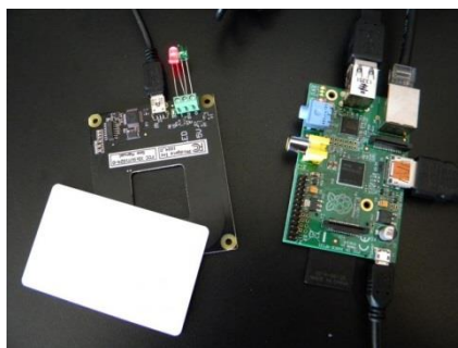
Figure 6 : Carte Phidget RFID (à gauche) connectée à un ordinateur Raspberry Pi (à droite)
