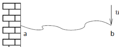
FIGURE 2.1 – Schéma d'une corde vibrante
