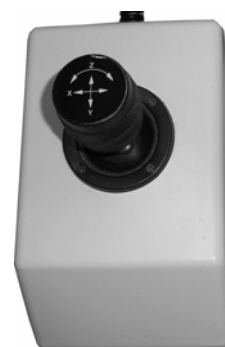
FIG. 3.8 – Joystick de contrôle de la platine du microscope AX-70.
