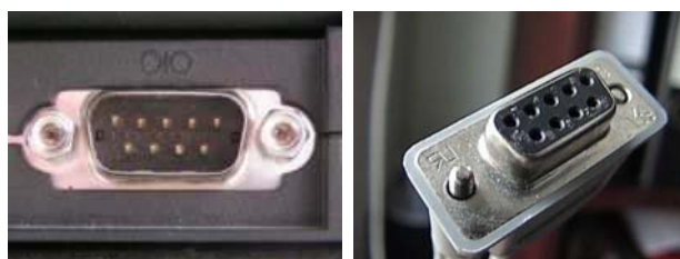
FIG. 2.14 – Connecteur RS232 à 9 broches, prise mâle (à gauche), prise femelle (à droite)
