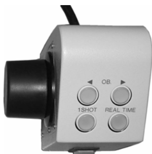
FIG. 3.7 – Bloc de commande de mise au point
