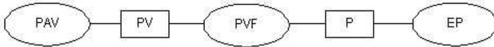
FIG. 3.12 – Arbre de jonction du réseau bayésien en 3.10 ( A = Aalborg ; P = Projet ; V = Vélo ; F = Fatigue ; E = Expérience )
