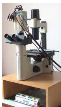
Figure 18 : microscope inversé utilisé lors du comptage et de la détermination des organismes planctoniques.
