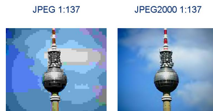
FIG. 3.2 – Comparaison JPEG et JPEG 2000 à même taux de compression. Image tirée de [MI]
