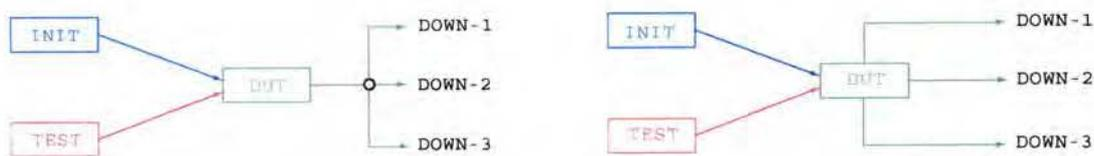
**Figure 8-1 : Représentation de l'utilisation d'une (g.) ou plusieurs (d.) interfaces de sortie pour l'envoi des messages aux voisins en aval du DUT**
