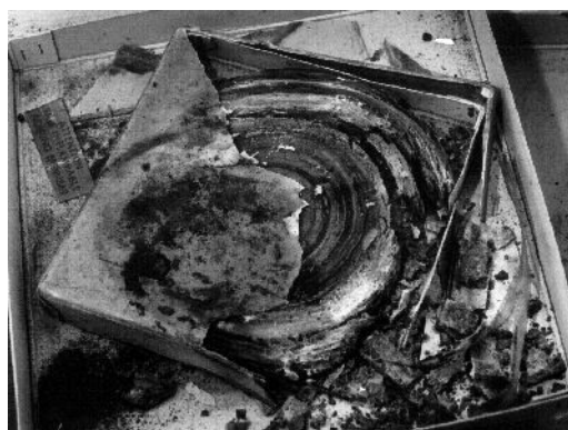
Figure 4.1 - Bobine en nitrate de cellulose à l'état de décomposition 27
