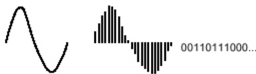
Figure 1.9 - Transformation d'un signal analogique en séquence binaire
