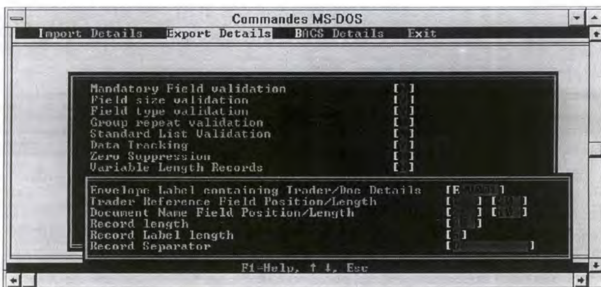
Figure 8.8: Boite de sélection des paramètres de format général des fichiers plats à exporter à records de longueur fixe.
