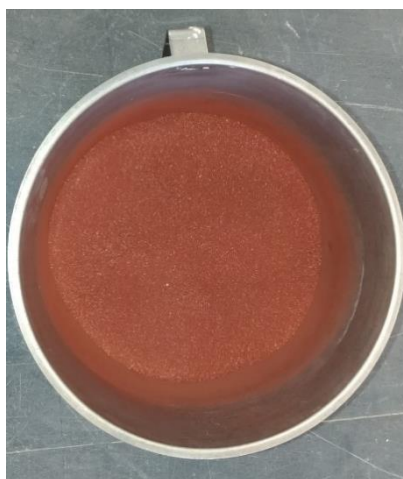
Figura 12 – Materiais secos misturados manualmente na cuba metálica
