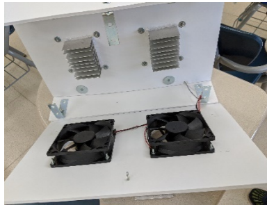
Figura 18. Implementación de las distintas partes. Se visualiza los disipadores con los ventiladores. Fuente: Propia.
