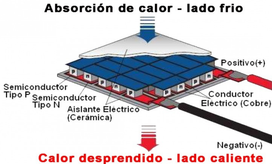
Figura 1. Funcionamiento de una celda Peltier. Fuente: techmake.com
