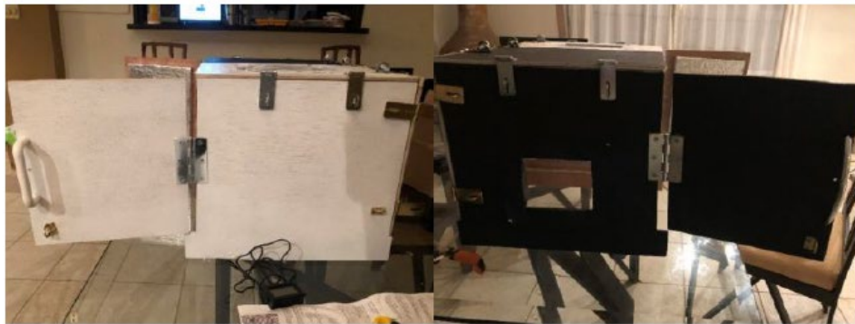
Figura 7. Ensamblado de las paredes laterales al techo y a la pared trasera. Fuente: Propia.
