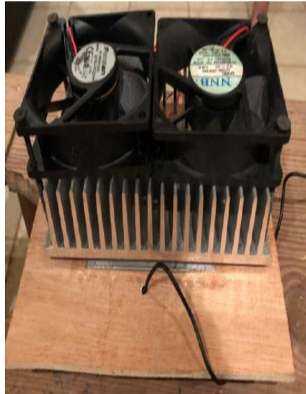
Figura 9. Agregado del módulo de enfriamiento en el orificio del techo para conectar a la batería. Fuente: Propia.
