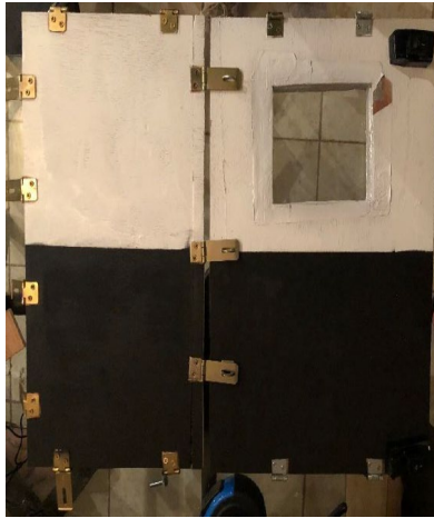
Figura 6. Ensamblado del techo con la pared trasera. Fuente: Propia.
