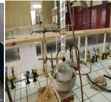
**Appareil du chauffage à reflux**
