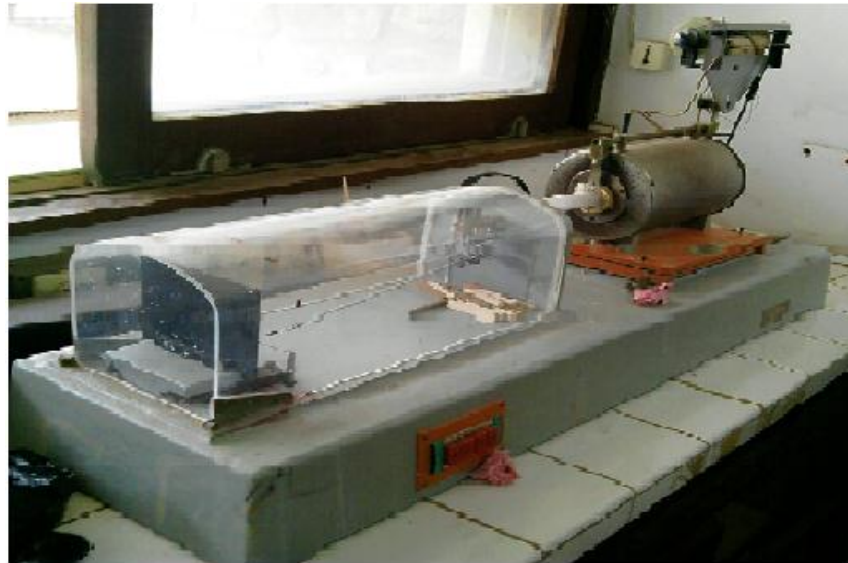
Figure 10 : Dilatomètre mécanique type Chevenard, modèle D.M. 15 simple.
