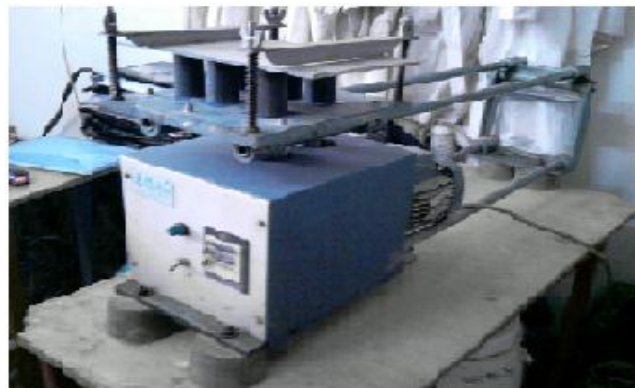
Figure 8 : Table vibrante électrique de marque M & O , type 202, N° 106
