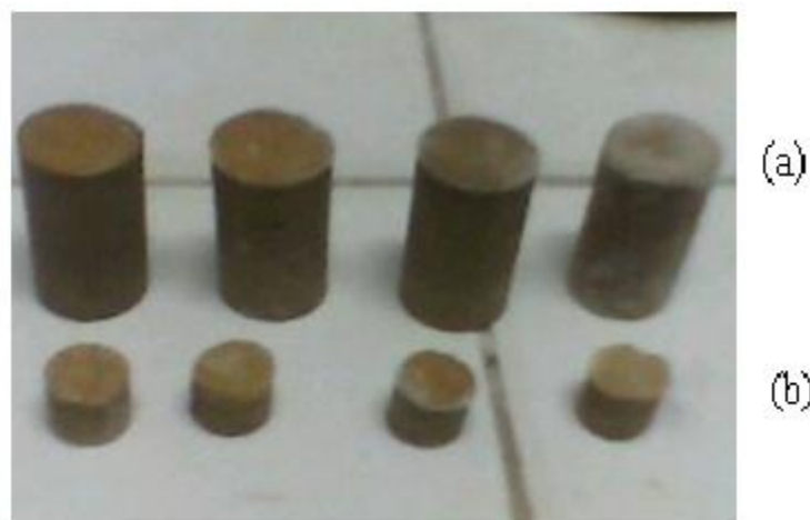
Figure 15 : Les éprouvettes GPM (a) et GPE (b) thermiquement non traitées.
