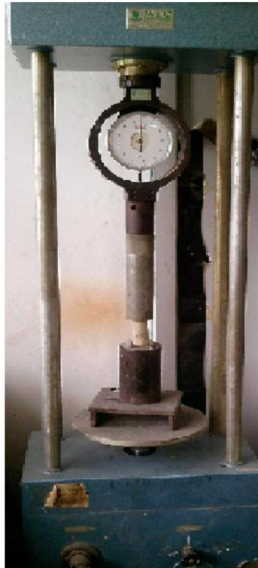
Figure 11 : Presse électro-hydraulique M& O , type 11.50, N° 21.
