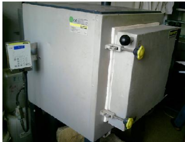
Figure 9 : Four programmable de marque Nabertherm
