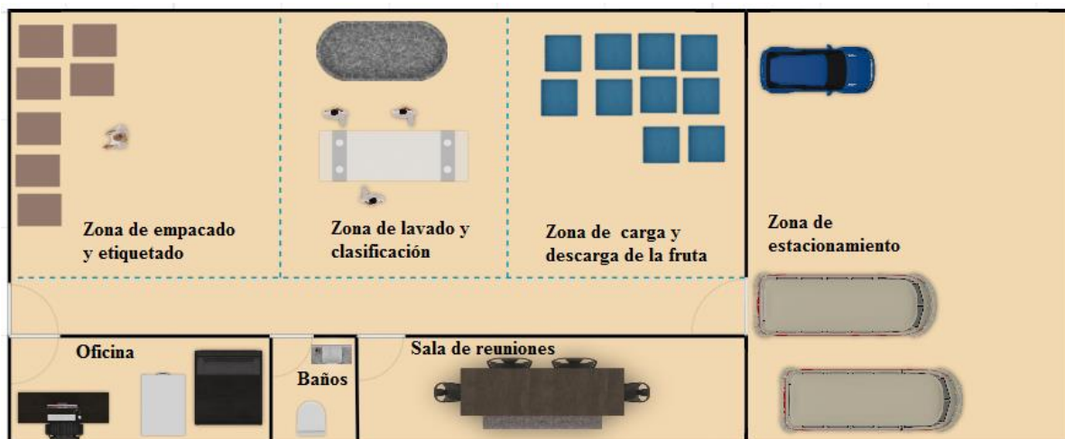
Ilustración 16. Diseño del centro de acopio
